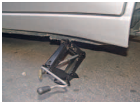
Zvedák založte na místo doporučené výrobcem vozidla
