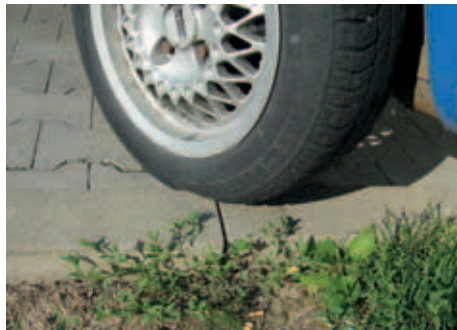
Riziko poškození pláště: špatné parkování na obrubníku
