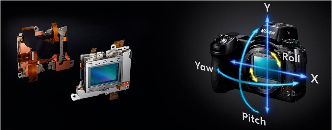
Jednotka mechanického stabilizátoru snímáče bezzrcadlovky
