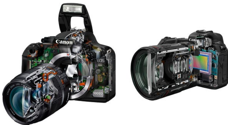
Schéma DSLR a bezzrcadlovky
