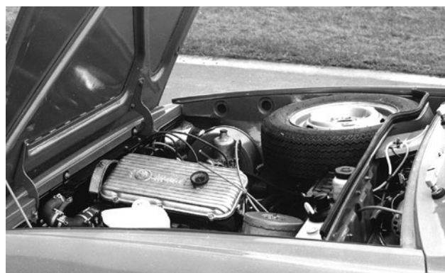
Kapota Š 760 se odklápěla kupředu, k motoru se vešlo i náhradní kolo
