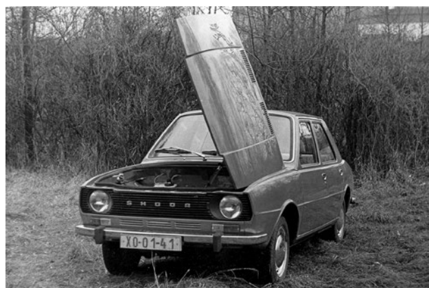
Š 727 měla jako první přední kapotu nezvykle zavěšenou po straně
