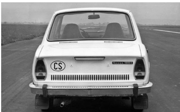
Prototyp Š 742/1 dostal jako první svislé zadní svítlny kapkovitého tvaru
