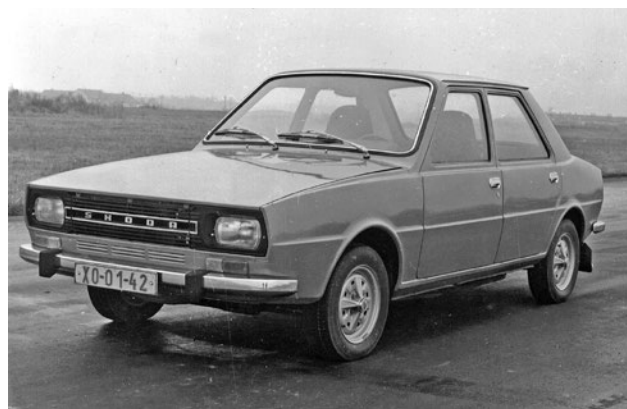
Š 760 s předním pohonem a upravenou karoserií Š 727 z prosince 1972
