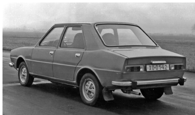
V zádi karoserie Š 760 se místo motoru skrýval prostor pro zavazadla
