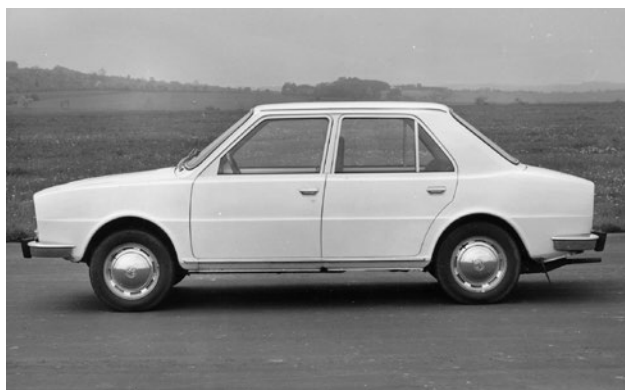
Ani prototyp Š 742/1 ještě neměl trojúhelníková okénka v předních dveřích
