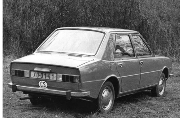
Zadní čelo karoserie Š 727 neslo vodorovné obdélníkové sdružené svítlny
