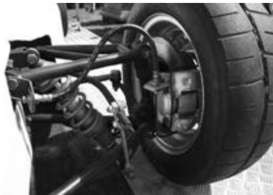
▲ Přední zavěšení kol monopostu MTX 1-05 si zachovalo jednoduchost řešení
