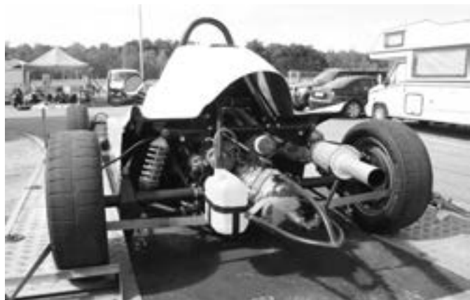
▲ Pohonná jednotka Škoda 105 byla v automobilu MTX 1-05 otočena i se čtyřstupňovou převodovkou o 180° kolem svislé osy, zadní náprava využívala sériových prvků řady Š 105/120
