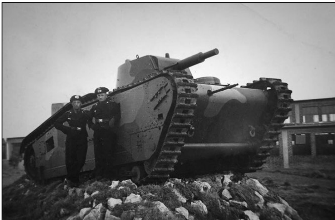
▲ Grosstraktor (velký tahač) byl střední tank, který v letech 1929 a 1930 vyrobily po dvou kusech tři různé společnosti: Krupp, Rheinmetall-Borsig a Daimler-Benz. Vozidla byla z nepancéřované oceli o tloušťce 13 mm a hlavní zbraňí byl kanón ráže 75 mm. V rozporu s Versailleskou smlouvou se v Sovětském svazu s Grosstraktorem prováděly utajované zkoušky, při nichž vyšlo najevo pouze omezené operační využití. Na snímku je jeden z tanků Krupp, vystavený u 5. obrněného pluku v německém Wünsdorfu. Z přední části vyčnívá kulomet. Bundesarchiv
