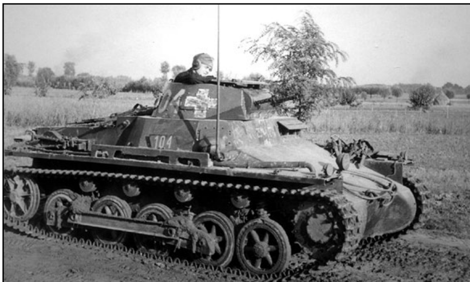
▲ Panzerkampfwagen I Ausf B zaznamenal několik změn oproti Ausf A, včetně zvýšení počtu pojezdových kol ze čtyř na pět a nosných kladek ze tří na čtyři na každé straně; zadní napínací kolo bylo u Ausf B zdvihnuté více nad úroveň terénu a dva tlumiče umístěné na blatnících byly vyměněny za jeden tlumič na zadní části korby. Snímek pochází z invaze do Polska v roce 1939. National Archives and Records Administration
