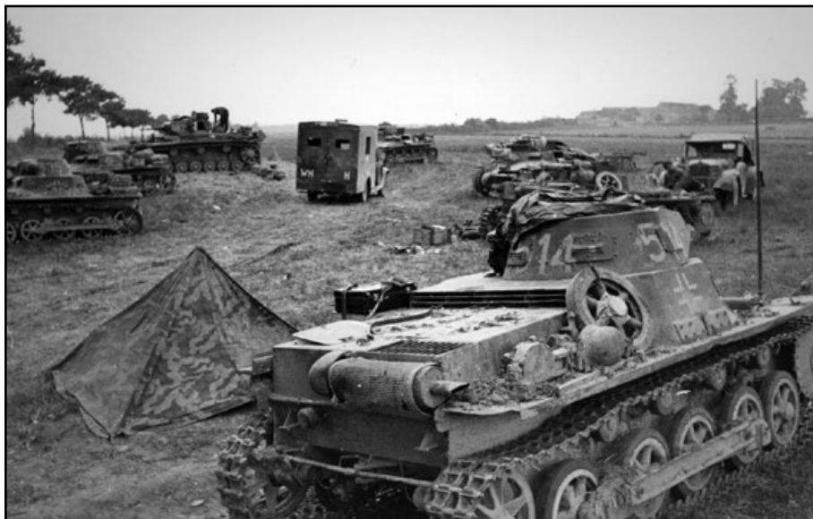
▲ Panzerkampfwagen I Ausf B z 36. tankového pluku 4. tankové divize, pohled ze zadu zprava na shromaždišti ve Francii během bleskové války v roce 1940. Je zde vidět rozdíl v uspořádání motorové plošiny v porovnání s Ausf A. Změnou bylo i umístění ocelové tyče mezi podpěry nosných kladek, které tak byly vyztuženy. National Archives and Records Administration
