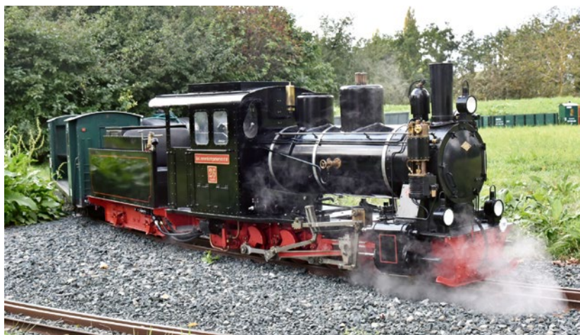
Obr. 23 Lokomotiva číslo 26 je modelem úzkorozchodné lokomotivy pomořanských okresních drah, a to v měřítku 1 : 3 na rozchodu 184 mm od profesionální firmy Balson
