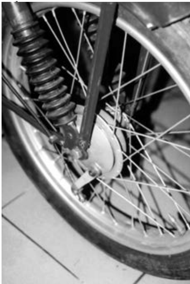
▲ Přední jednostranná bubnová brzda v detailu
