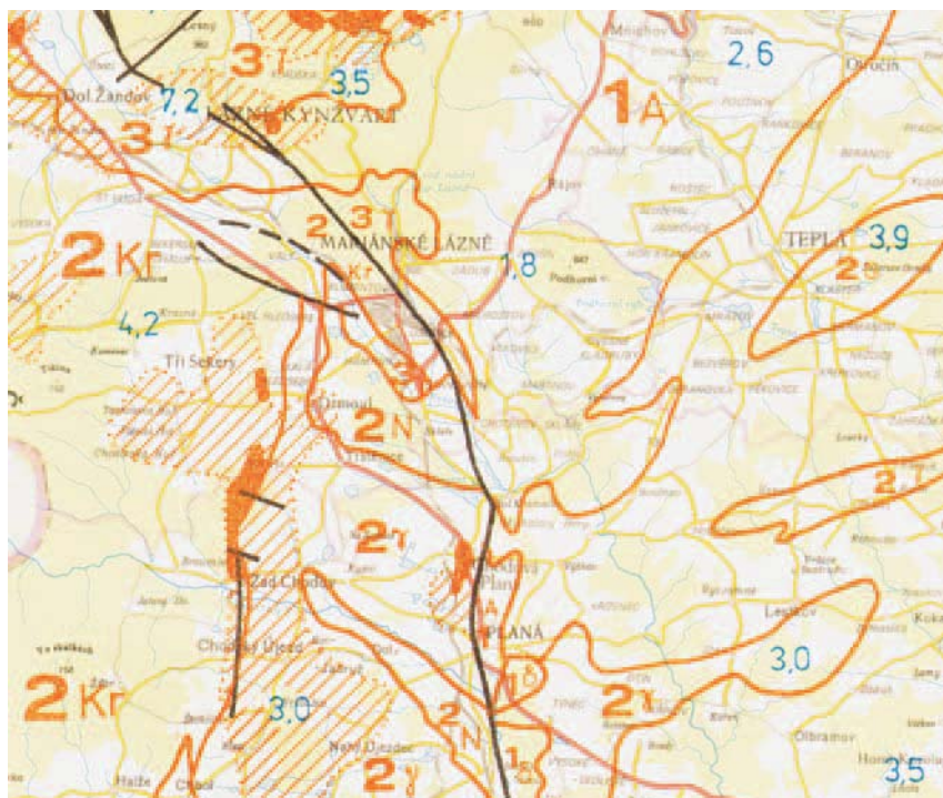
Obr. 5 Výřez z Odvozené mapy radonového rizika ČR v M 1 : 200 000 (symbol 1 odpovídá převažujícímu výskytu nízkého radonového rizika, symbol 2 převažujícímu výskytu středního radonového rizika, symbol 3 převažujícímu výskytu vysokého radonového rizika, vyšrafovaná část výskytu anomálních hodnot); ÚÚG 1990
