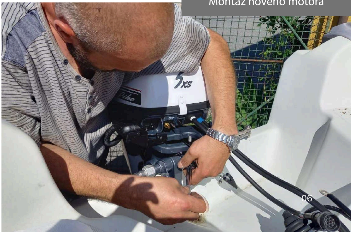
Montáž nového motora
