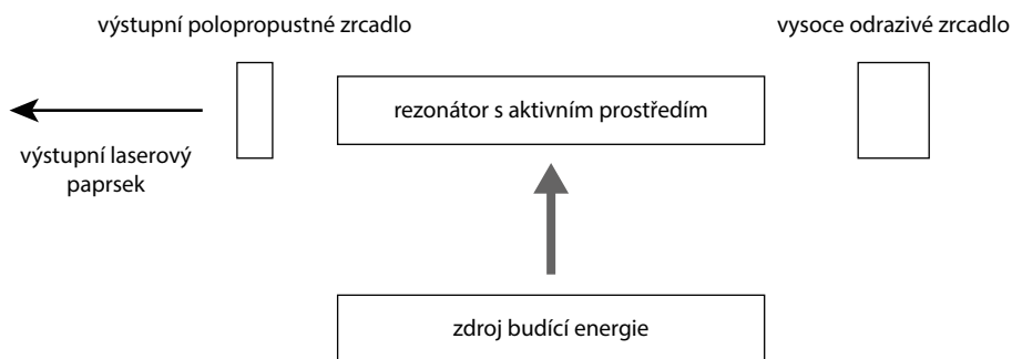
Obr. 2.5 Schematické znázornění hlavních součástí laseru
