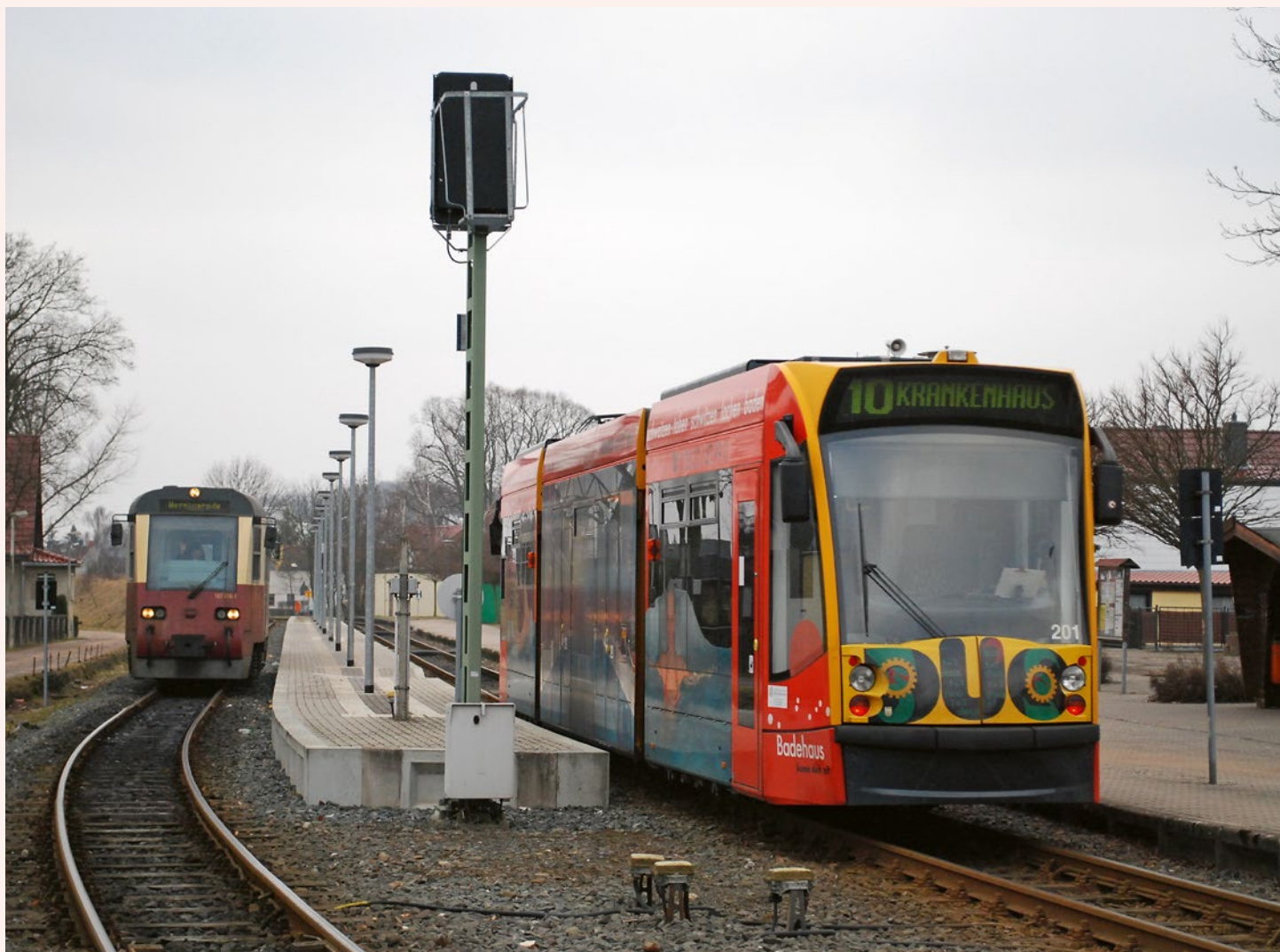
Německé město Nordhausen provozuje jednu linku tramvaje jako tram-train. Vozidla jsou na železniční infrastrukturu poháněna vznětovými motory
