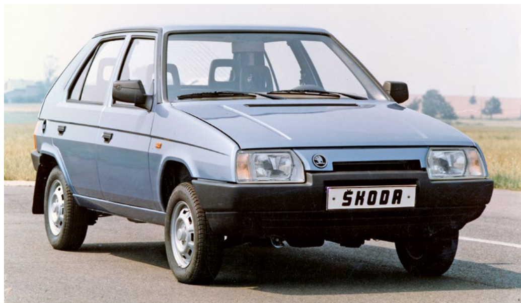
S motorem vpředu napříč a předním pohonem: Škoda Favorit 136 L
