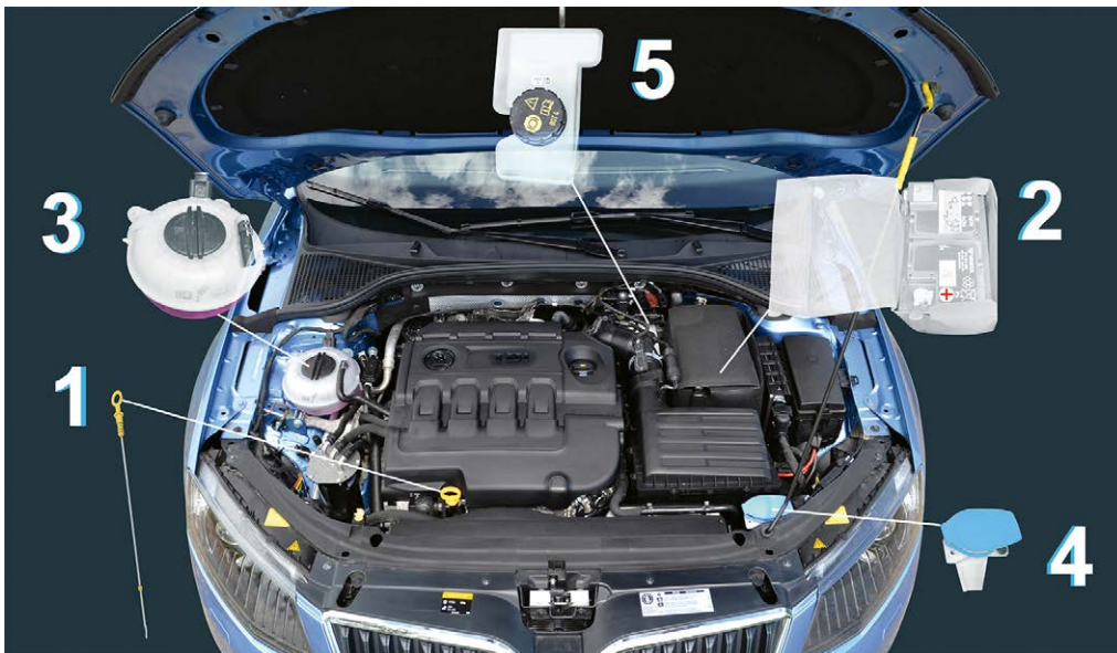
1 – měrka pro kontrolu množství oleje v motoru, 2 – akumulátor, 3 – expanzní nádoba pro kontrolu množství chladicí kapaliny, 4 – víčko zásobníku oštrikovací kapaliny, 5 – vyrovnávací nádržka brzdové kapaliny
