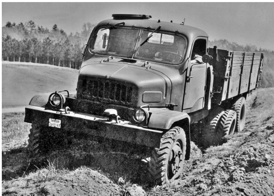
Prototyp vozidla již s šestiválcovým motorem T 912 při továrních zkouškách. Na nárazníku je připevněna bílá tabulka „ZKOUŠKA ZA-91-69“. Masky a kapota motoru ještě není v definitivní sériové podobě
