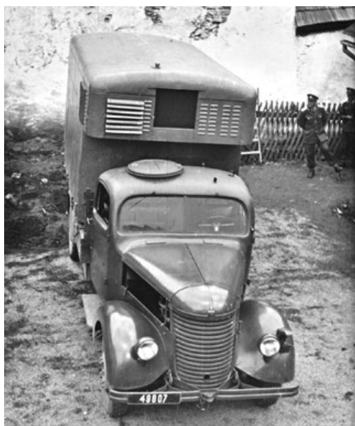
Praga RN: chladič přepravník masa
