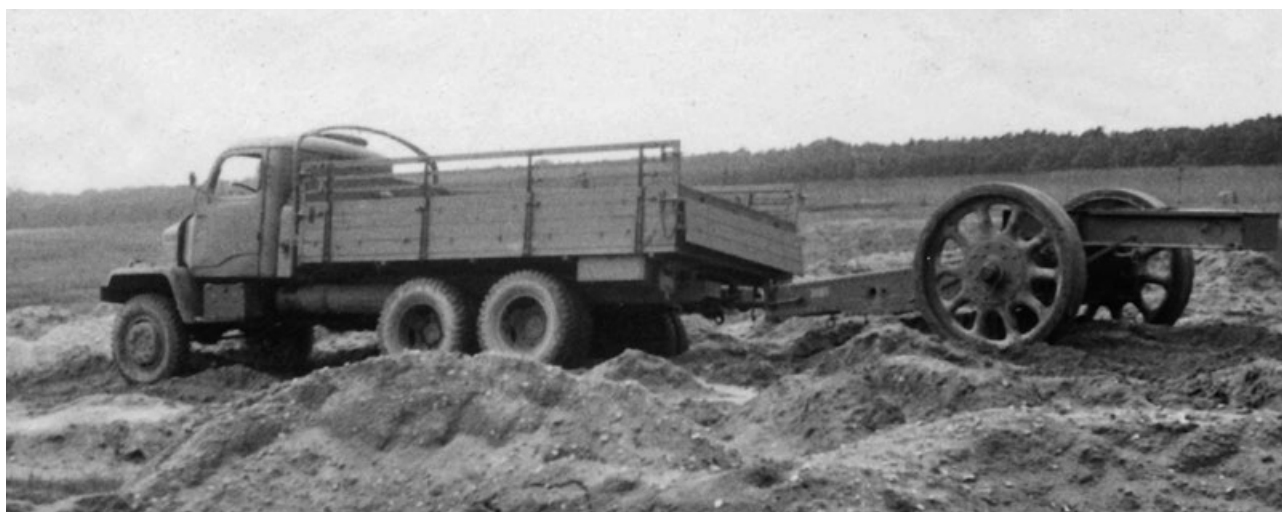
V3S/I s německou dělovou lafetou při zkoušce v písčitém terénu na vojenském cvičišti za Starou Boleslaví [1]
