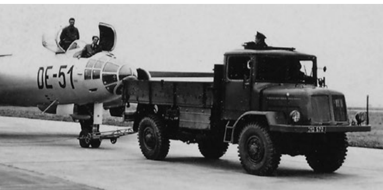
T 128 jako tahač bombardéru Il-28, Přerov (7. listopadu 1955)
