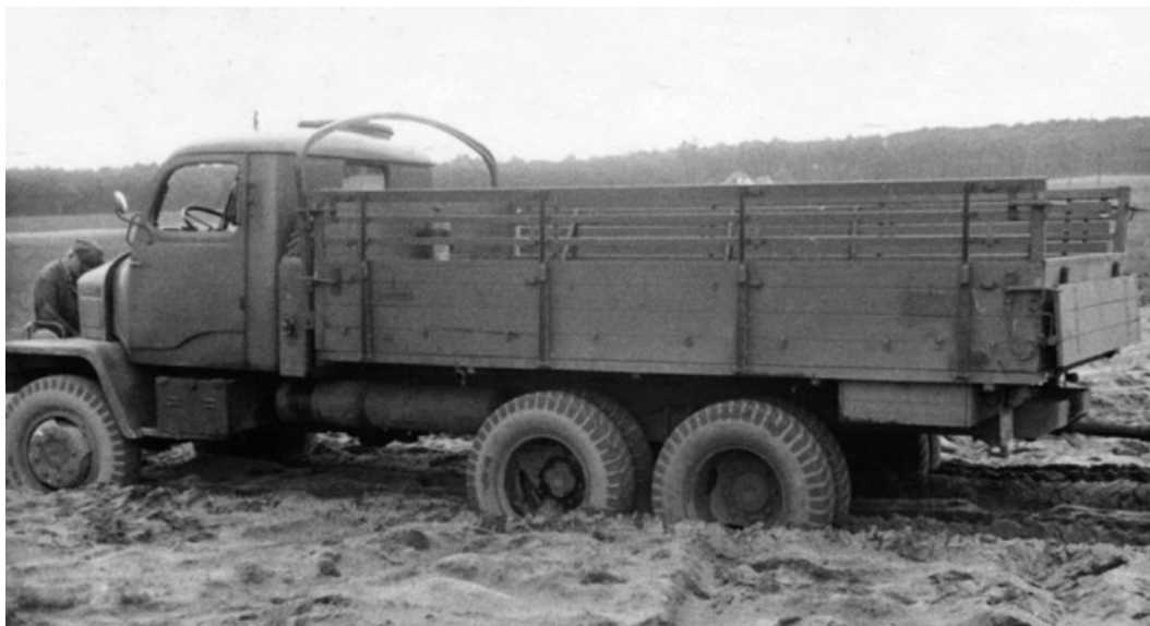
Detailní záběr na prototyp V3S/I, pod kabinou řidiče schrána na akumulátory (cvičiště u Staré Boleslavi) [1]
