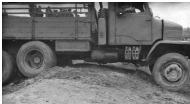
Prototyp V3S/I s pohotovostním vzduchojemem na pravé straně pod kabinou řidiče, záběr z terénních zkoušek na cvičišti Motol [1]
