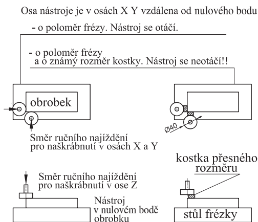
Obr. 1.10: Frézka – stanovení nulového bodu obrobku naškrábnutím a přes kostku
