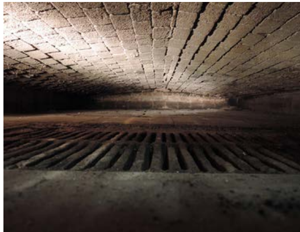
Obr. 1.21 Roštnice v přední části pece
