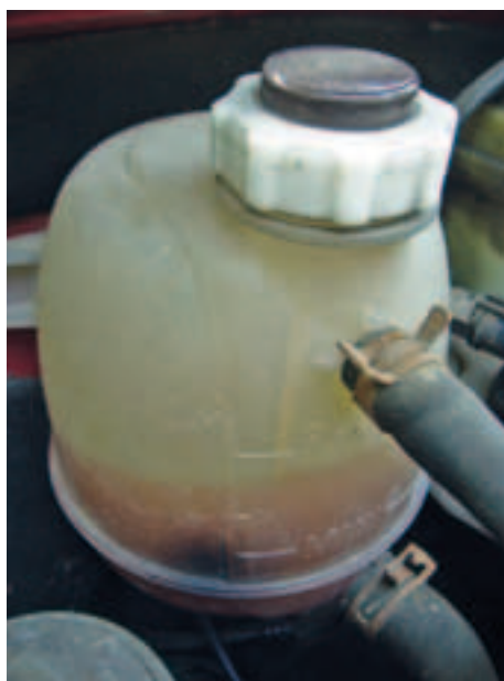
Nádobka chladicí kapaliny s ryskami
