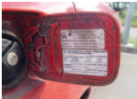
Štítek s předepsanými hodnotami pro nahuštění pneumatik
