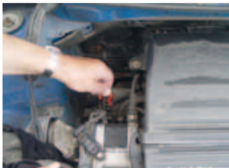
Umístění olejoměry v motorovém prostoru
