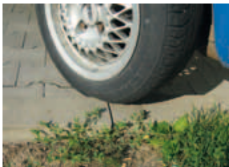
Riziko poškození pláště: špatné parkování na obrubníku
