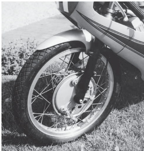
Přední bubnová brzda v detailu. Díly z elektronu byly odlity v ČKD Platiště
