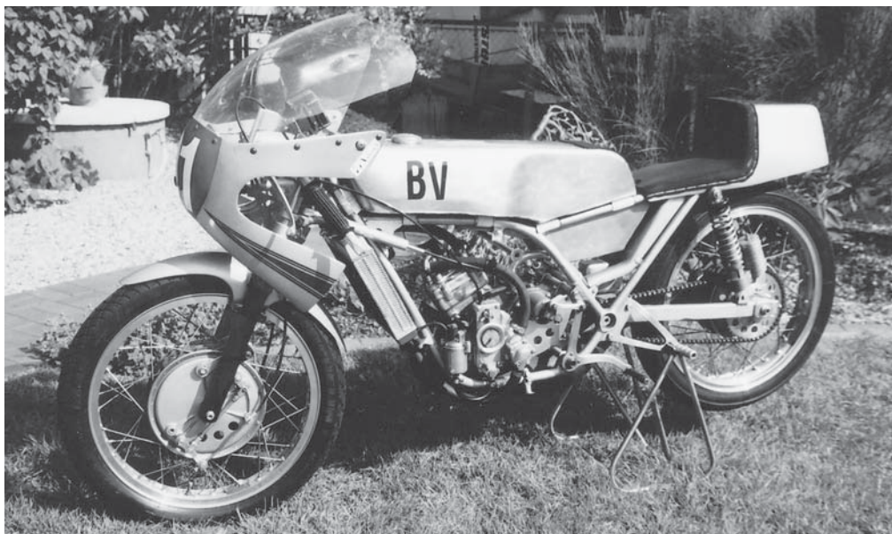
BV 125 druhé generace s kapalinou chlazeným motorem po sejmutí kapotáže
