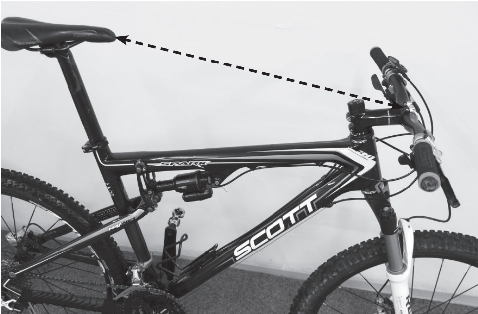
Obr. 9 Vzdálenost středu řídítek od špičky sedla
