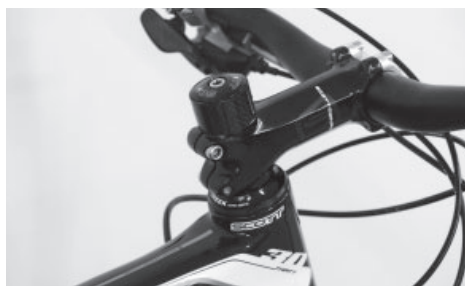
Obr. 8 Nastavení výšky řídítek pomocí podložek na představci
