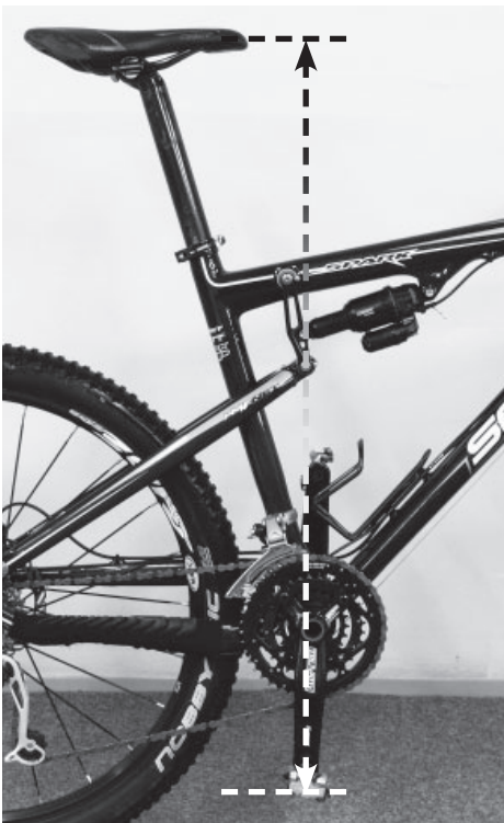
Obr. 10 Vzdálenost osy pedálu a vršku sedla
