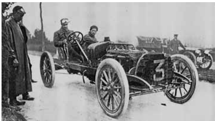
Obr. 1.10 Vůz Clement Bayard z roku 1904 byl koncipován s ohledem na minimální čelní plochu, s trubkovým chladičem a nádrží mezi motorem a jezdcem
