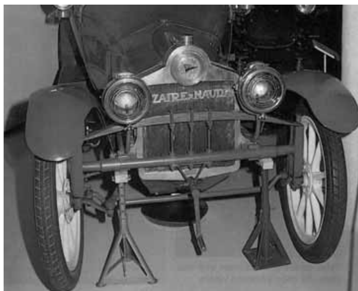
Obr. 1.13 Nezávislé odpružení přední nápravy vozu Sizaire-Naudin
