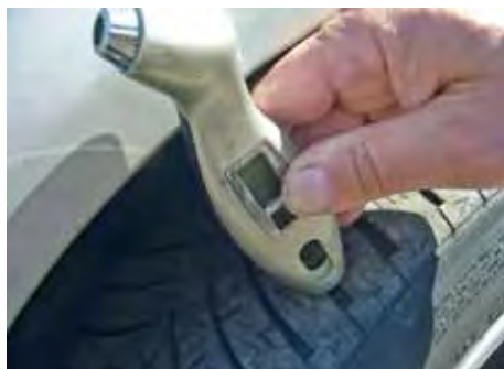
Měření hloubky vzorku pneumatiky
