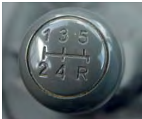
Schéma řazení na řadicí páce
