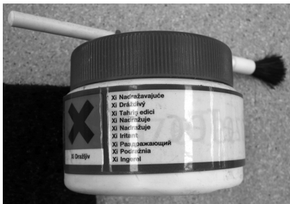
Obr. 19 Letovací pasta je zdraví škodlivá a práce s ní je spojena s velkou mírou rizika poškození zdraví (viz popis)
