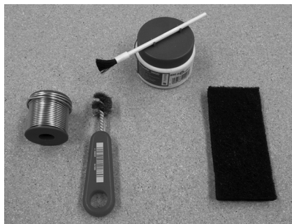
Obr. 18 Potřeby pro svařování měděného vodovodního potrubí – letovací pasta, pájka, čistící kartáček a čistící pemza
