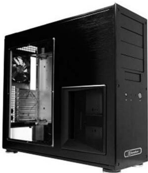
Obrázek 1.3: Počítačová skříň bez komponent
