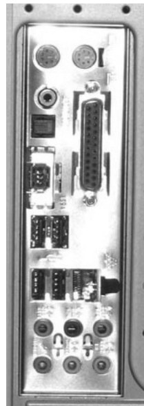
Obrázek 1.12: Zadní strana PC obsahuje barevně označené konektory
