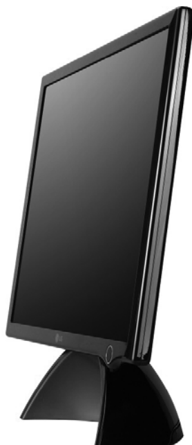
Obrázek 1.2: LCD obrazovky jsou skladnější a mají nižší elektromagnetické vyzařování
