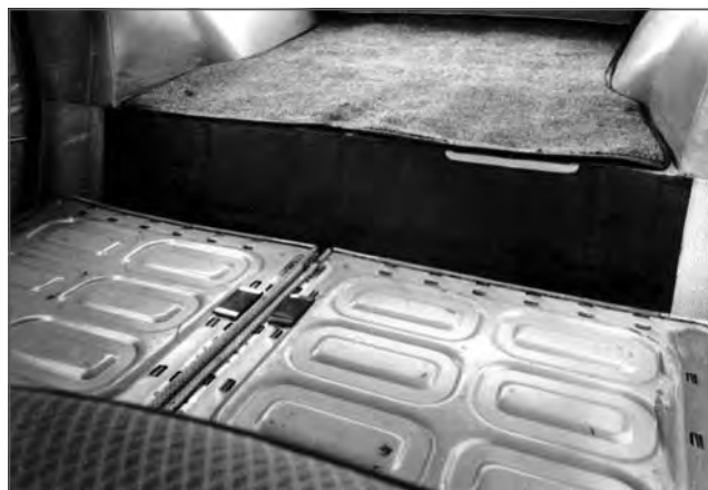
Kryt motoru tvořil schod v podlaze kombi
