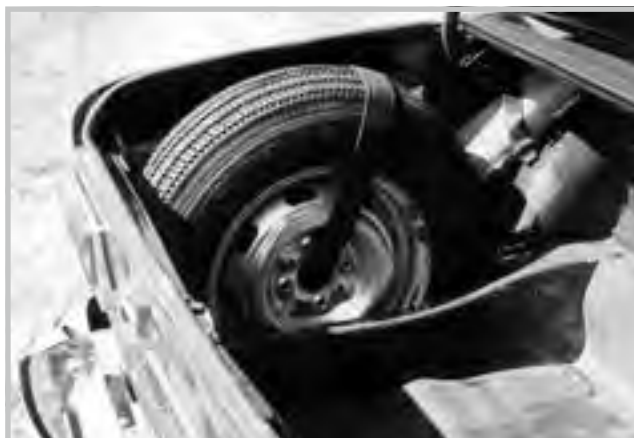
Náhradní kolo bylo uloženo za levým zadním podběhem
