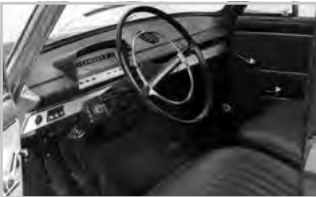
Střídmá palubní deska s obdélníkovým sdruženým přístrojem
