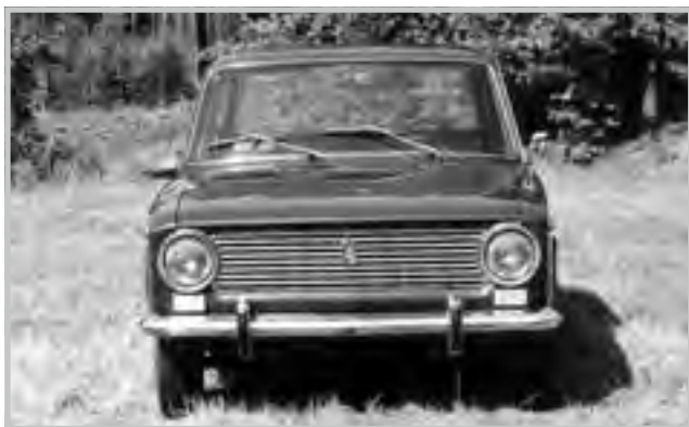
V předním nárazníku měl VAZ-2101 otvor pro natáčecí kliku
