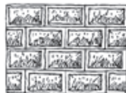
opus rusticum – rustica (čelní plochy hrubě opracovány špičákem)
