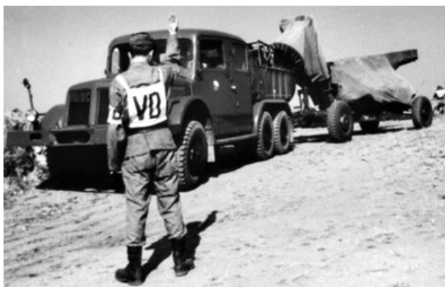
Tatra 141 s odpalovacím zařízením SM-90 protiletadlového raketového kompletu S-75 Volchov v pochodové poloze
