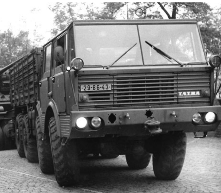
Sériové provedení tahače Tatra 813 8 × 8 (ev. č. 29-86-43)
