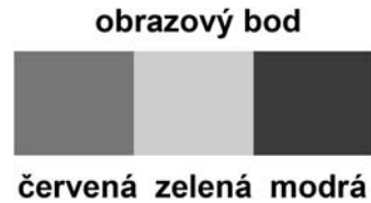
Obr. 1.11: Schéma zastoupení barevných kanálů v barevném bodu
