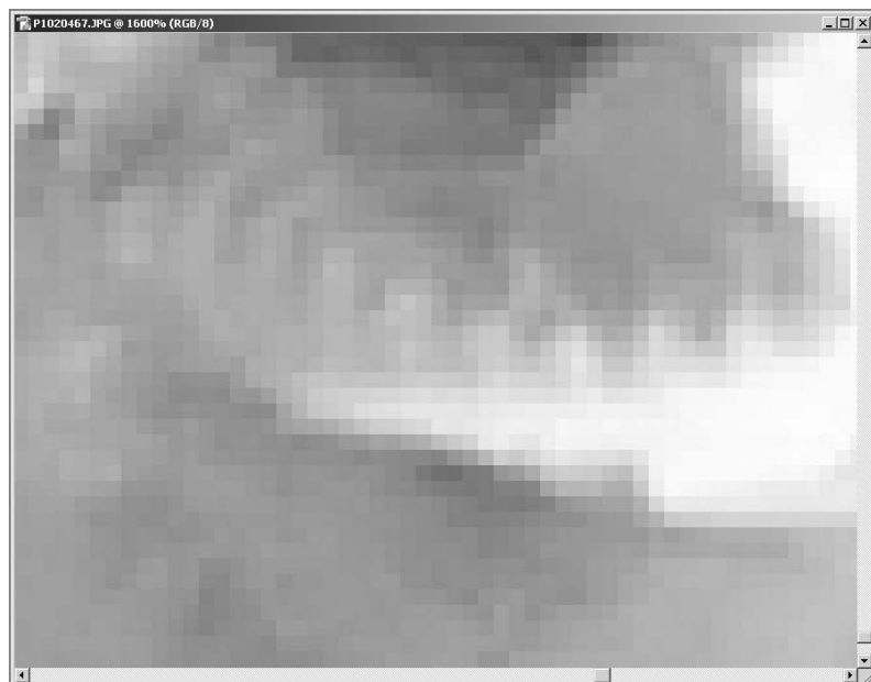
Obr. 1.10: Obrazové body viditelné u extrémně zvětšené fotografie
