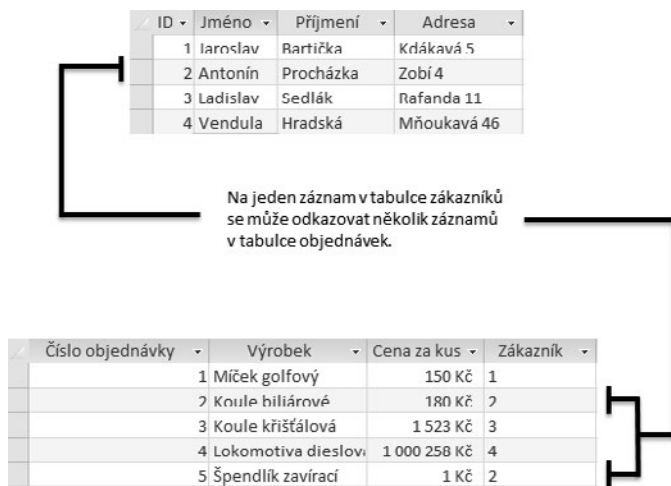
Obrázek 2.4: V relační databázi se tabulky propojují pomocí relací
