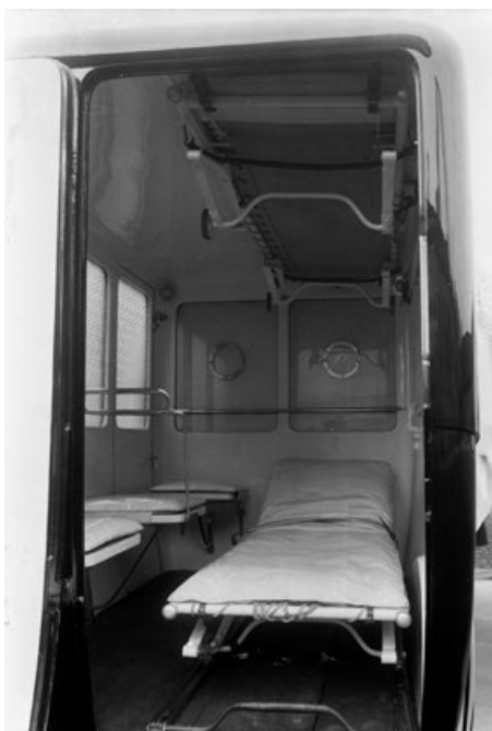
■ Pohled do sanitního prostoru s horními nosítky vytaženými ke stropu
