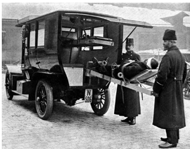
■ Hlavní přístup do sanitního prostoru otvírala vyklápěcí zadní stěna karoserie
