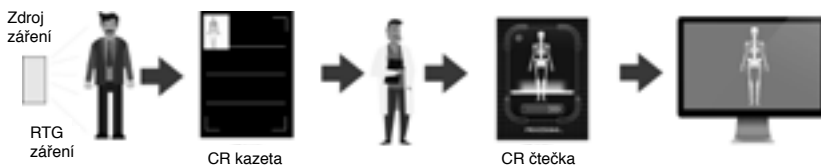
Obr. 9: Princip nepřímé digitalizace
