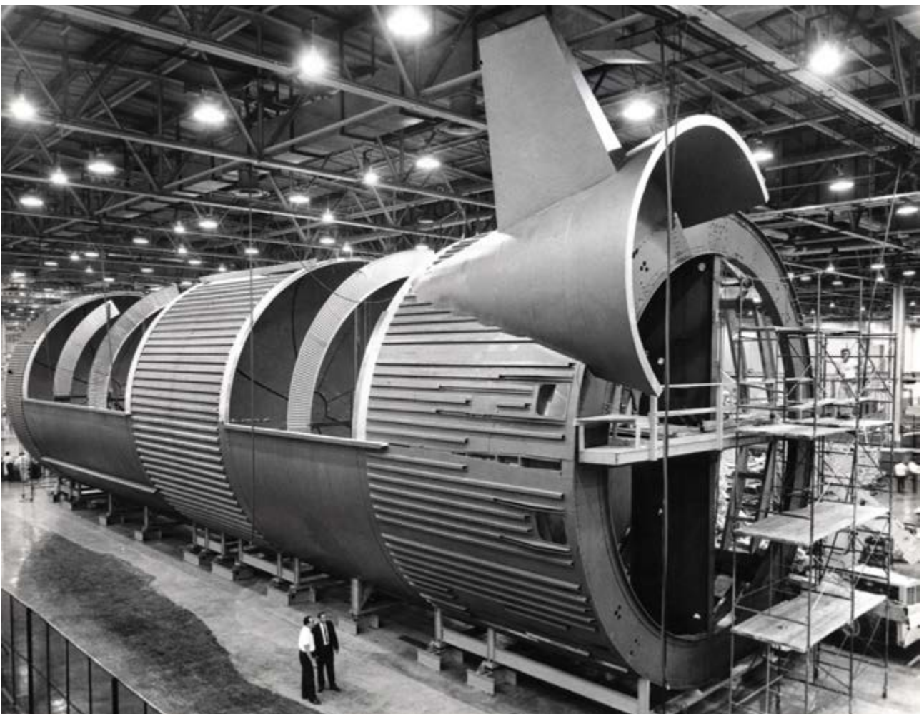
V dielňach firmy Boeing vznikla najskôr rozmerová maketa prvého stupňa S-IC rakety Saturn V.
