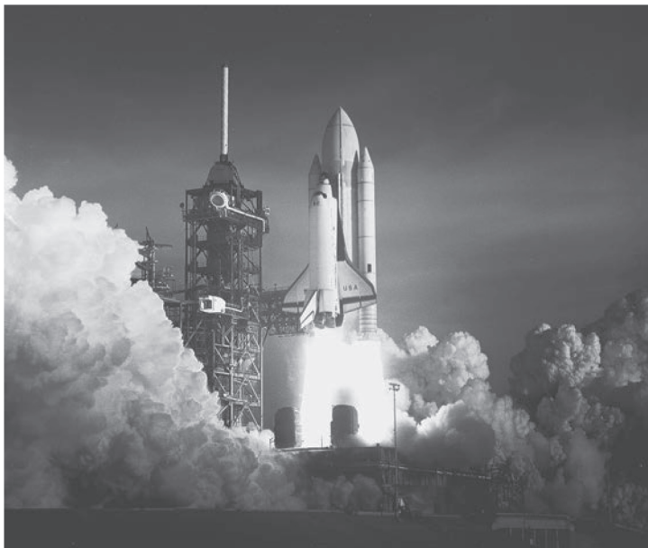
Raketoplán poháňaný parou: Viacnásobne použiteľná kozmická loď agentúry NASA sa dostala do vesmíru vďaka reakcii kyslíka s vodíkom za vzniku vody.
