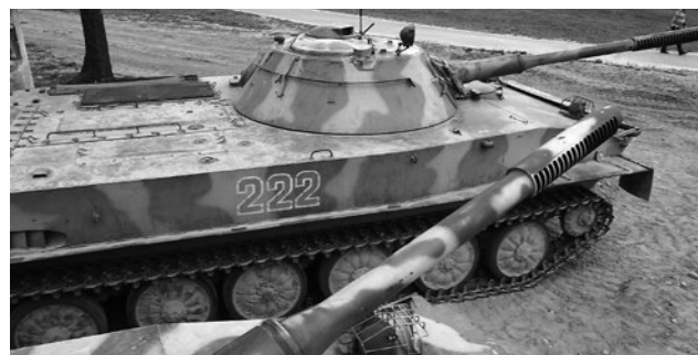
PT-76 s původním 76,2mm kanónem LB-76T (D-56T), muzeum Stalinova linie, Bělorusko
