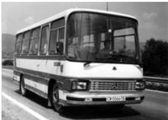
Malý autobus Čavdar LC 51 byl v malém množství exportován i na území bývalého Československa. Prototyp byl vyroben v roce 1980 a sériová výroba se rozeběhla až v roce 1983. Autobus byl stavěn na českém standardním podvozku Avia A 31N a byl vybaven dvěma typy motorů – buď licenčním Perkins-Diesel DP 5800 A nebo českým čtyřválcem Avia 712-18.0
