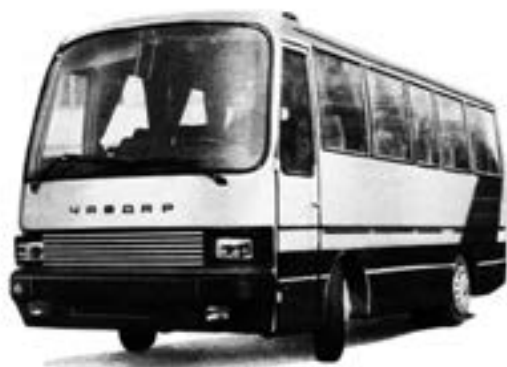
Čavdar 410 byl sedmimetrový midibus, typově podobný licenční modelové řadě 430 a 530. Tento autobus pro 30 sedících cestujících byl určen pro potřeby linkové, případně dálkové meziměstské dopravy
