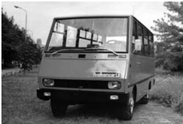
V roce 1980 byl inženýrem Petko Miševem navržen design malého autobusu Čavdar 5 S s náhonem pouze na zadní nápravu, který byl určen pro 16 cestujících. Tento typ autobusu se nedočkal většího rozšíření
