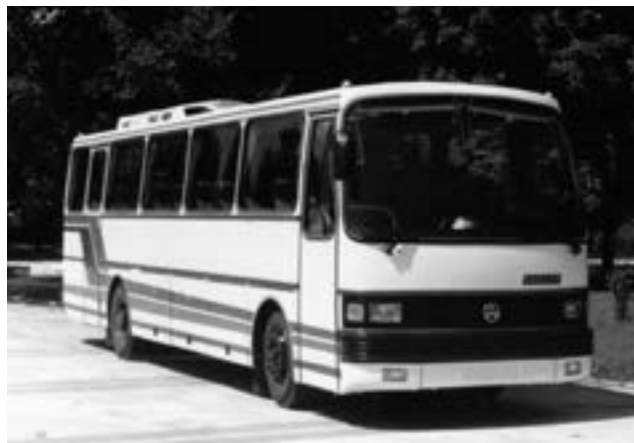
Čavdar 430 byl v licenci vyráběn západoněmecký autobus Kässbohrer Setra S 215H. Tento model nabízel 53 míst k sezení a mohl jet maximální rychlostí 125 km/h, k čemuž pomáhal vznětový pětiválec MAN D 2865 LOH-EURO 1 o výkonu 198 kW při 2000 otáčkách za minutu
