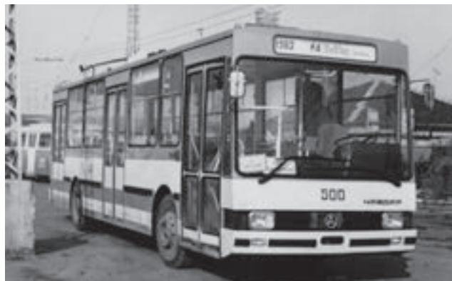
Začátkem osmdesátých let se i Bulhaři pokusili o vlastní výrobu trolejbusů. A tak byl roku 1982 vyroben prototyp standardního trolejbusu Čavdar T 13-30, postavený na bázi autobusu B 13-20
