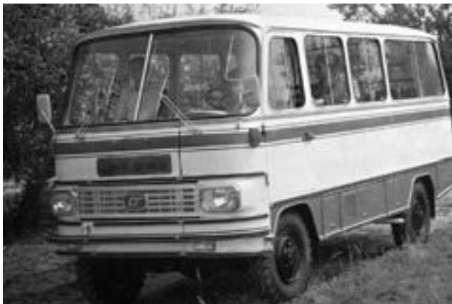
Na archívním záběru z roku 1977 je prototyp autobusu Čavdar 5S 4×4 s pohonem na všechna kola. Výroba tohoto autobusu s licenčním vznětovým čtyřválcem Perkins-Diesel začala až v roce 1980
