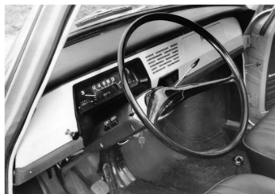
Palubní deska prototypu Š 718 TS osazená lichoběžníkovým sdruženým přístrojem
