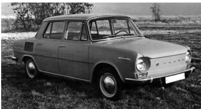
Sedan Š 718 TS z podzimu 1965 se poprvé obešel bez prolisů pod klikami dveří
