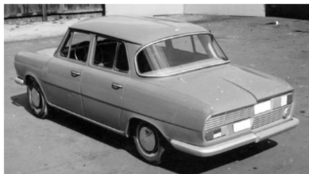
Základem makety byl jeden z padesáti vozů NOV v sádrovém převleku
