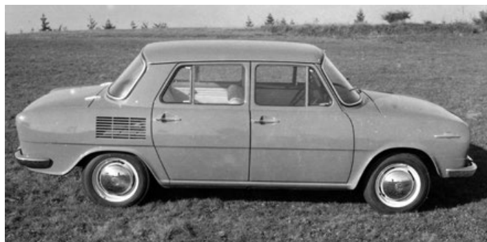
Karoserie Š 717 měla kabinu se širokými zadními sloupky a plochou střechou
