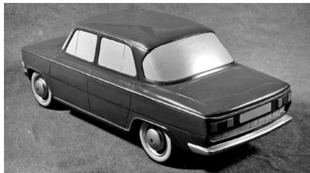
Model z jara 1963 měl zadní svítlny umístěné nahoře, nad mřížkou
