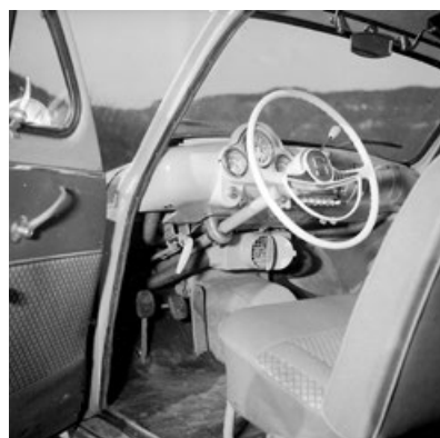
Palubní deska automobilu Škoda 440 Export s řadicí pákou u volantu
