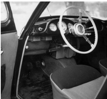
Symetricky řešená palubní deska prvního prototypu a volant z Tatraplanu
