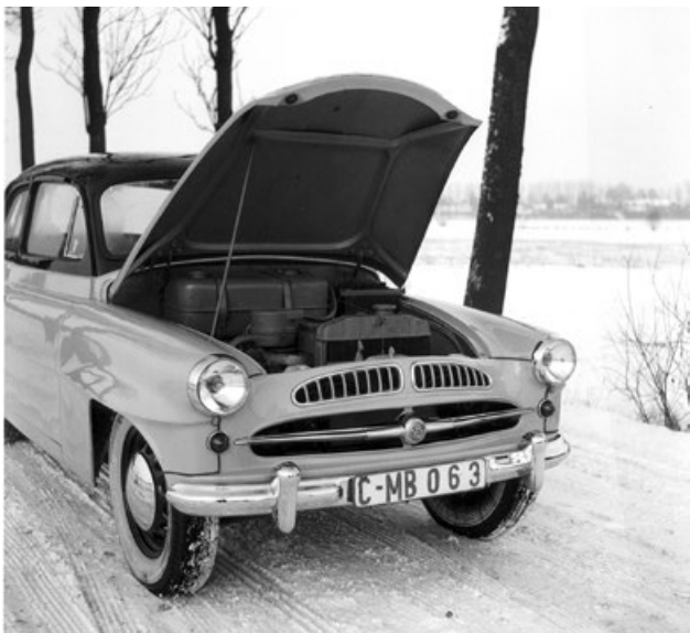
První prototyp měl palivovou nádrž umístěnou vpředu pod kapotou
