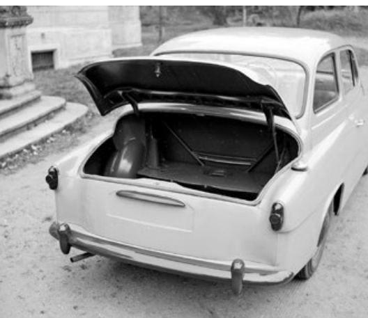
Víko zavazadlového prostoru držela v otevřené poloze trubková vzpěra
