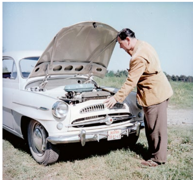
Pod kapotou se skrýval čtyřválec OHV 1089 cm 3 o výkonu 40 k SAE
