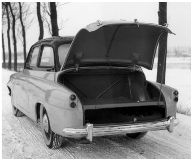
Víko zavazadlového prostoru prototypu zabíhalo až dolů k nárazníku
