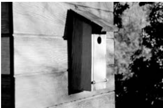
Obr. 1 Lazurovací povrchová úprava masivního dřeva v exteriéru
