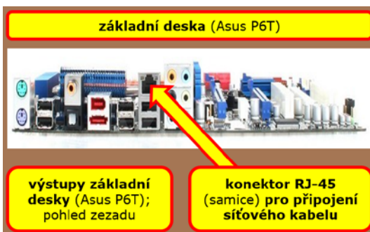
Obrázek č. 1.4: Základní deska; výstupy (pohled zezadu)
