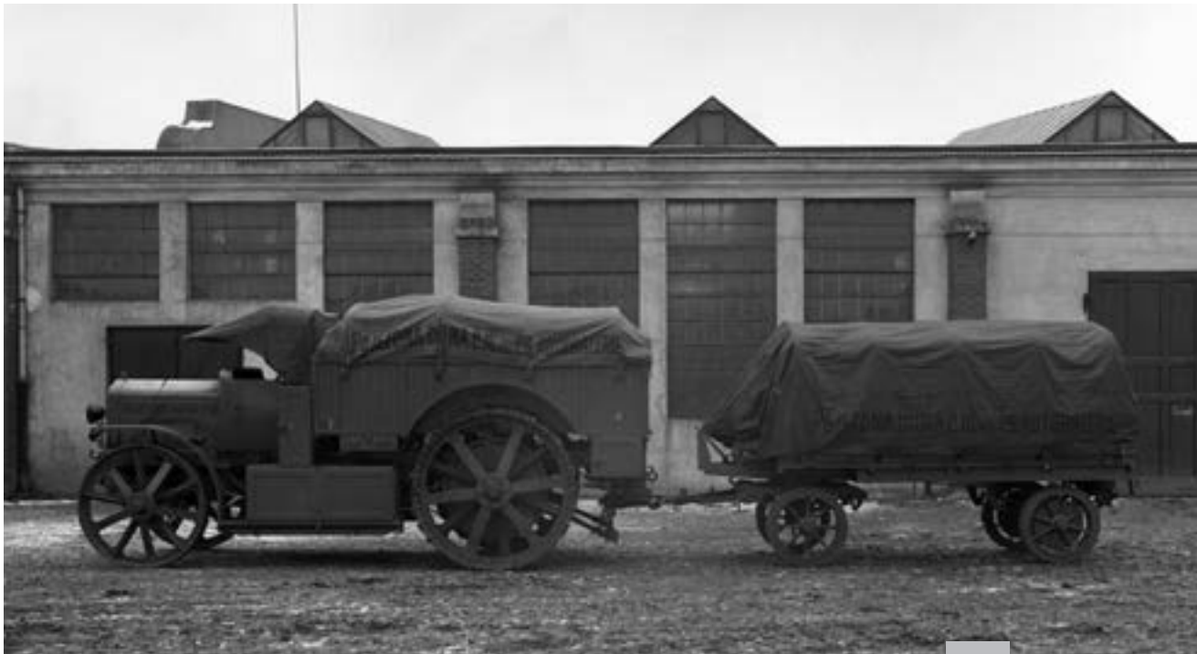
Pojízdná dílna československých autobaterií. Na nádvoří plzeňské Škodovky stojí jedna z dokončených dílenn na podvozku typu „U“ s přívěsem
