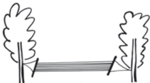
Vodorovný provizorní rám upevněný mezi kmeny stromů
