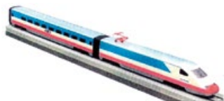
Vysokorychlostní vlak ŠKODA pro rychlost 300 km/h. Prototyp určený pro zkoušky na EVRU v roce 1996.
