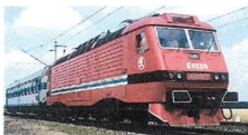
Elektrická lokomotiva typu 85E. Modernizace po zkouškách a v možnostech využití nové techniky např. IGBT tranzistorů pro měniče. Zvýšení rychlosti na 140, 160 nebo 200 km/h.
