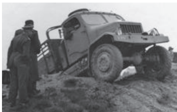
Prototyp V3S/III, přední maska a přední nárazník mají jiný tvar než známe ze sériového provedení
