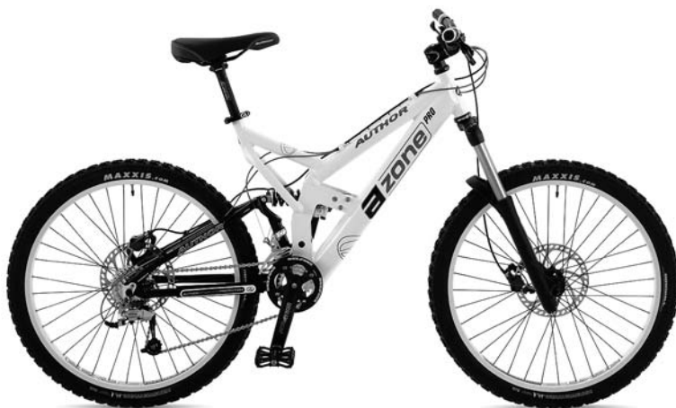
Obr. 7 MTB s odpruženou přední vidlicí a zadním odpružením rámu
