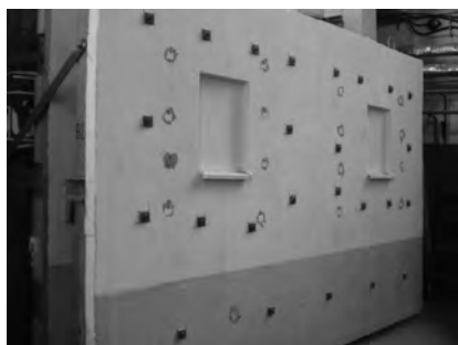
Obr. 6 Odtrh – panel – příprava na odtahové zkoušky
