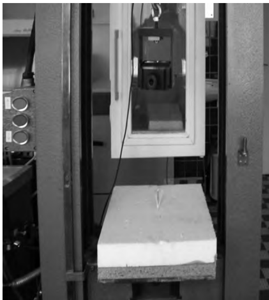
Obr. 11 Zkušební přístroj pro zkoušku protážení hmoždinky izolačním
