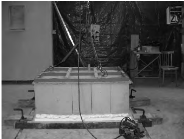
Obr. 9 Pěnový blok – ukázka testovacího přístroje
