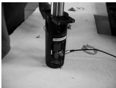
Obr. 7 Odtrh – zkušební přístroj k provedení testu
