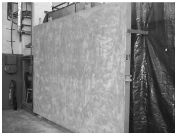
Obr. 1 Zkušební stojan pro zkoušení systémů ETICS
