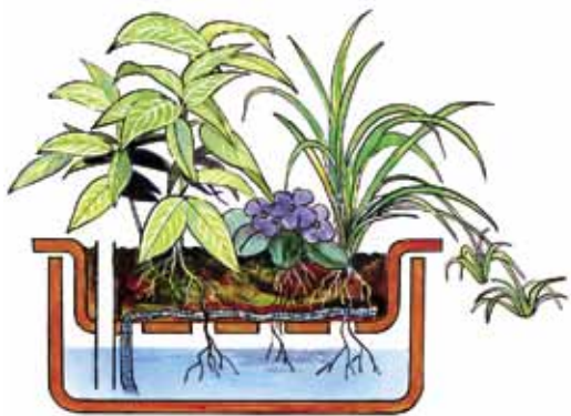
Samozavlažovací květináč s nalévací trubkou. Zdvojení stěn brání ohřívání nádoby se zeminou na slunci.
