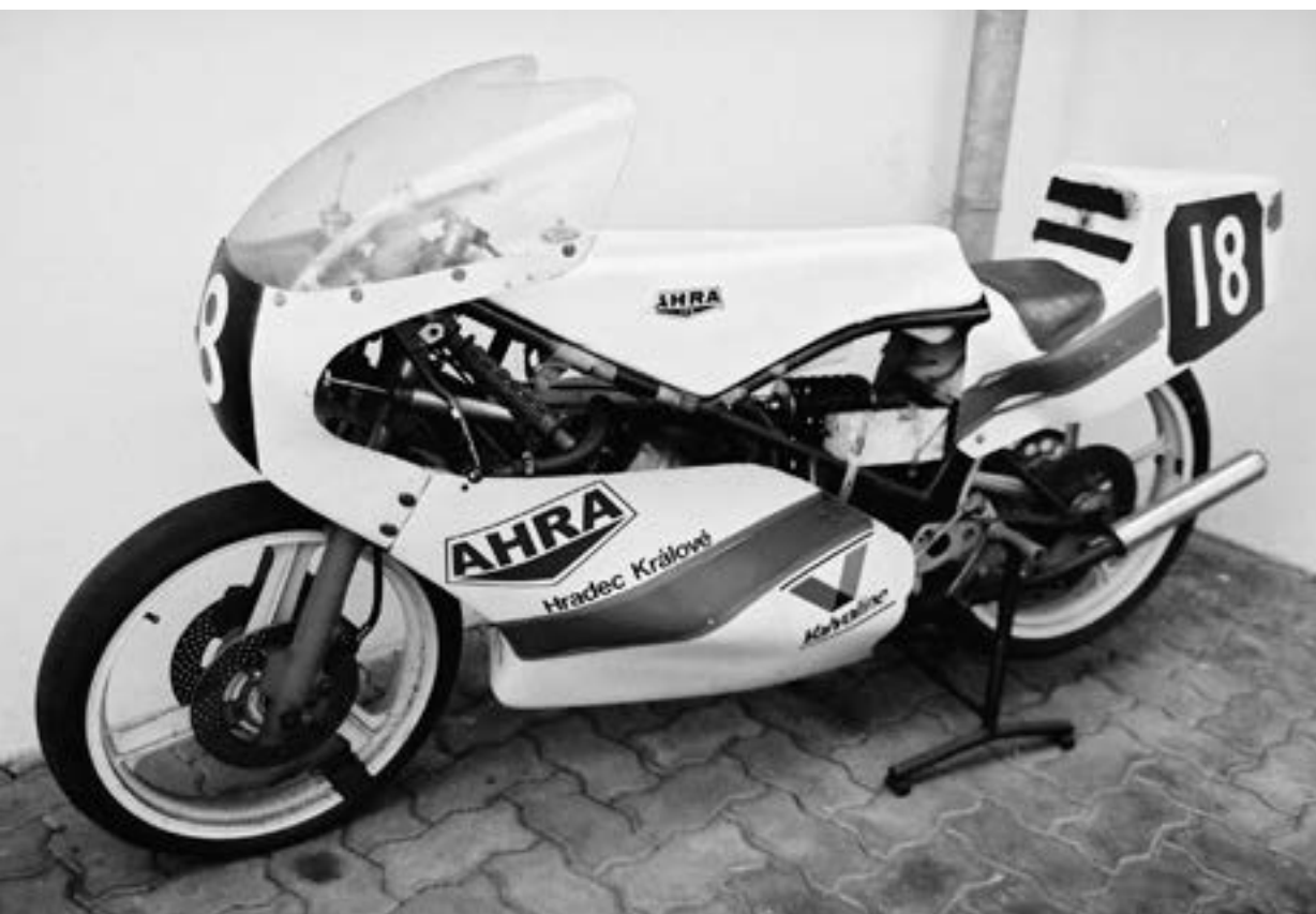
Poslední Ahra 125 s kotoučovými brzdami, paprskovými koly a odpružením Cantilever
