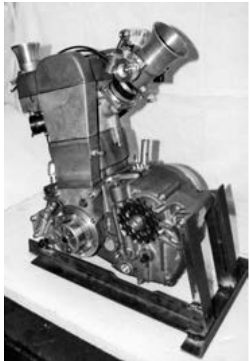
Detail nového čtyřdobého jednoválce Ahra 800 TOHC
