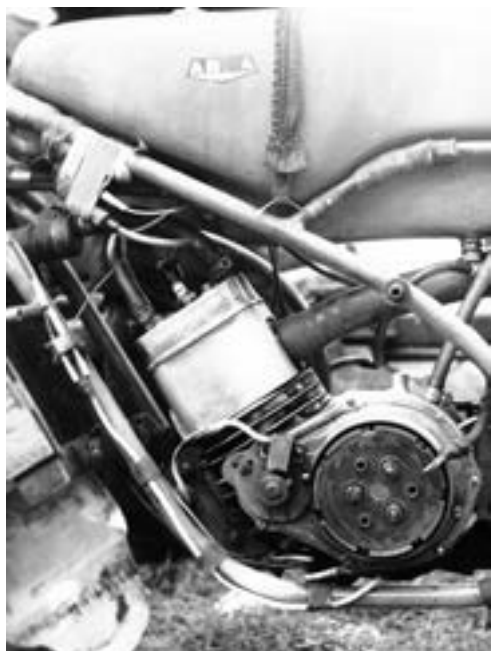
Kapalinou chlazený jednoválec Ahra 125 v detailu
