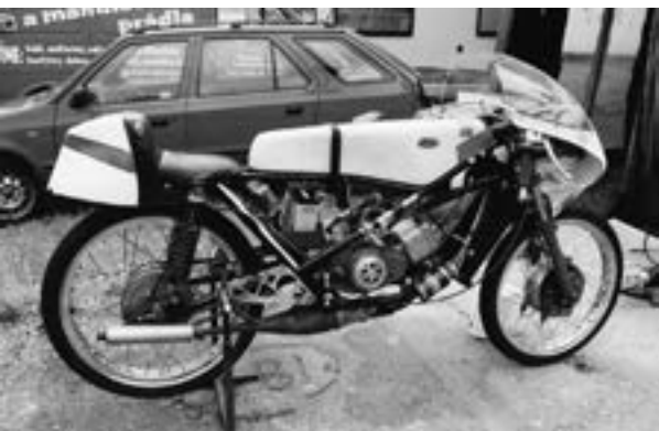
Oboustranný pohled na jednoválcovou padesátku Ahra (1972) po sejmutí kapotáže
