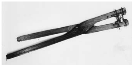
■ obrázek 7 Dřevěné kleště s kovovými formičkami na mačkání skleněné bižuterie, počátek 19. století. MSB
