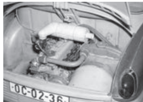
Druhý vůz Š 977 měl v zádi vodou chlazený řadový čtyřválec
