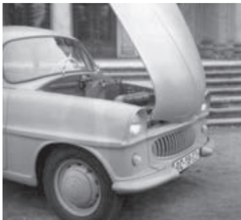
U Š 978 se kapota motorového prostoru odklápěla kupředu
