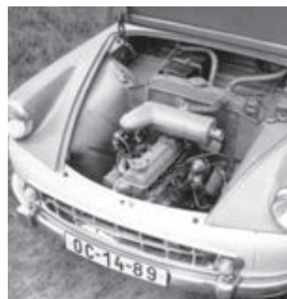
Š 976 měl motor podélně před přední nápravou a chladič za ní
